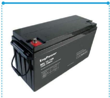
Свинцово-кислотные аккумуляторные батареи произведены по технологии AGM (электролит, абсорбирован в стекловолоконном сепараторе). Аккумуляторы являются герметизированными, необслуживаемыми, с системой рекомбинации газов (VRLA).
